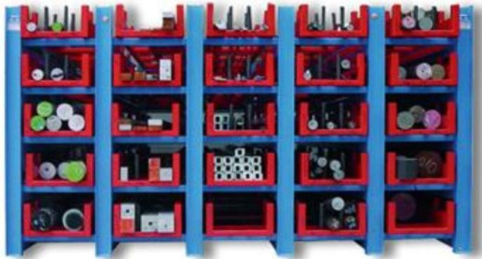
2- Stockage de barres en alvéoles (sources : [rack stockage tubes | Segema](#))
